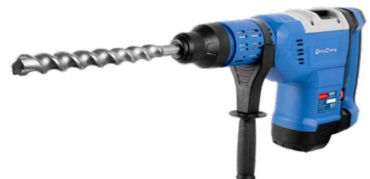
1500 W de alta calidad con un diámetro máximo de perforación de 1-3/4". Tiene las funciones de Rotomartillo, martillo eléctrico y demoledor para satisfacer las necesidades más condiciones de trabajo. Arranque más suave y seguro. Control electrónico de velocidad constante, salida continua con pequeño volumen y alta potencia. El mandril de cambio rápido SDS-Max es versátil y fácil de reemplazar. Tecnología confiable de embrague de seguridad para garantizar un uso seguro.
